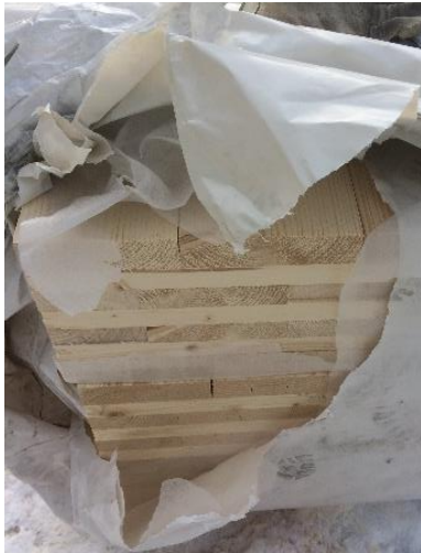
Bild 3. Mottagningskontroll av KL-skivor/bjälklagselement. 2018-02-22
